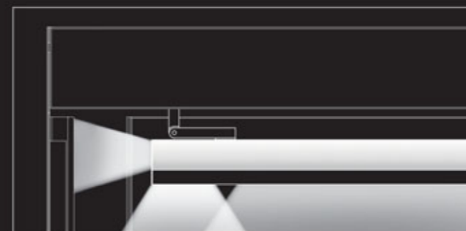
LD5X-LED Esquema de funcionamento iluminação directa-indirecta Luz LED branca neutra Ascensores Color Glas® / Corte vertical
