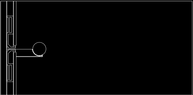
Corte vertical do painel lateral, lado do corrimão. Suporte central do corrimão, apoio.
